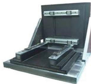
(a) 复合材料-金属混合机床结构
